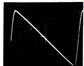
Bild 7. Das Raster des Oszillogradschirms gestattet die Kontrolle der Linearität des Sägezahns
